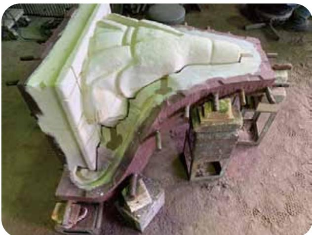
写真5 粘土原形から石膏型を制作
